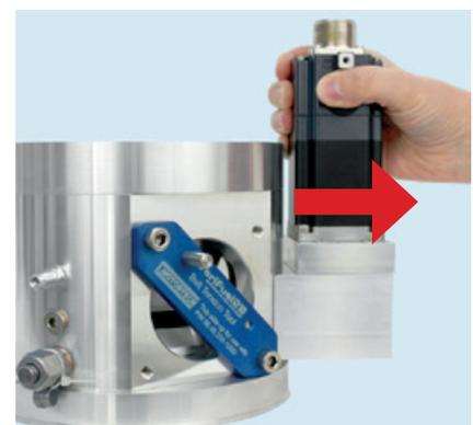
Der Antriebsriemen wird gespannt, indem der Schrittmotor so weit wie möglich nach oben gezogen und fixiert wird. Nach der Demontage des Einstellwerkzeugs hat der Riemen nun die optimale Spannung.
