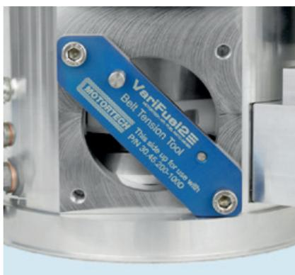
Das Einstellwerkzeug wird mit den beiliegenden Schrauben auf dem vorher geöffneten Gaseinlass fixiert.
