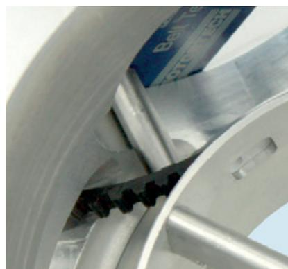
Der auf dem Einstellwerkzeug montierte Spanndorn drückt nun an auf den Zahnriemen und lenkt diesen um ein definiertes Maß um.
